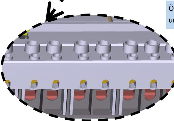
Unverlierbare Schraube, Käfigklemmen, Zusatzklemmen entsprechend allen Phasenklemmen, Hoher Schraubenlochrand für Finger-sicherheit und gegen die Kurzschlussgefahr.
