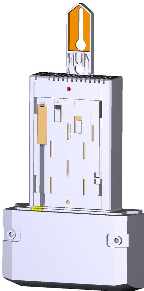
Holley BKE (eHZ-Adapter) entspricht DIN V VDE V 0603-5 und dient der Aufnahme von elektronischen Haushaltszählern (eHZ) gemäß VDN-Lastenheft. Der Adapter wird mit den schrankseitig vorhandenen Schrauben wie ein herkömmlicher Zähler auf dem Zählerkreuz befestigt.
