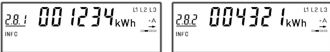
Die 6 Registerwerte 1.8.0, 1.8.1, 1.8.2, 2.8.0, 2.8.1 und 2.8.2 sind abrechnungsrelevant. Sie werden immer entspricht der Variante in der ersten Zeile des Displays und nur kWh ohne Nachkommastelle dargestellt.
