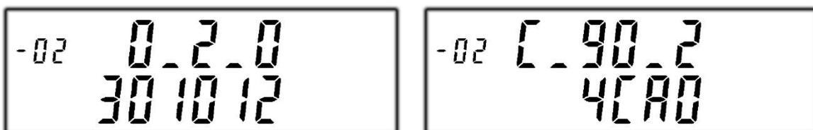
Rollierende Anzeige von abrechnungsrelevanten Werten. Die Anzeige der Momentanleistung auf zweite Zeile muss durch PIN-Eingabe freigeschaltet werden:
