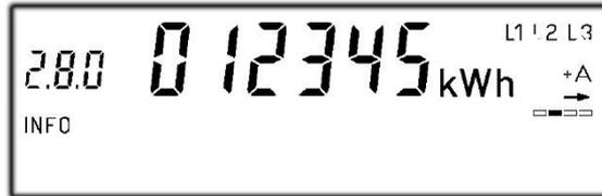
Variante Doppeltarif der Stromrichtung -A: abwechselnde Anzeige zwischen Register 2.8.1 und 2.8.2
